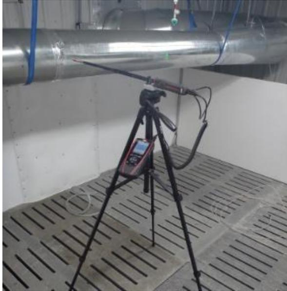
Système de conduites et anémomètre à fil chaud employés pour l'estimation du débit de ventilation.
