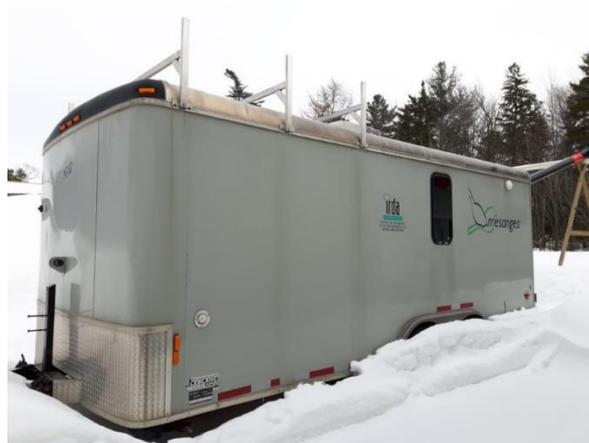
**Figure 16. Laboratoire mobile MESANGES de l'IRDA, installé près de la pouponnière #3 du site AGR d'Avantis Coopérative pour la mesure en continu des émissions à la sortie des ventilateurs.**
