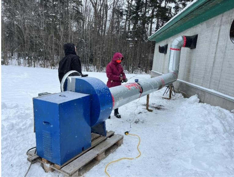
Figure 17. Montage utilisé pour la calibration standardisée des ventilateurs.
