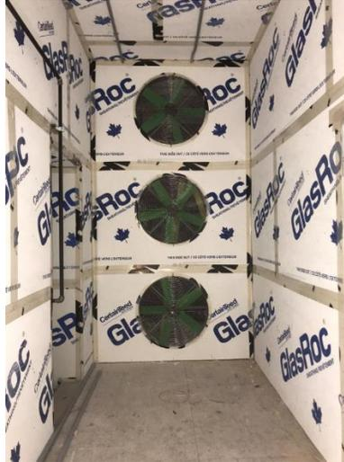
Figure 12 Ventilateurs de pressurisation de 32" sur un côté du bâtiment
