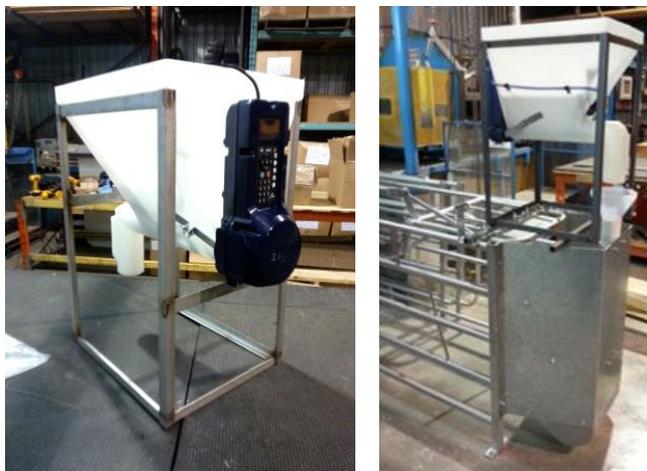
**Figure 48 Réservoir d'aliment et système Gestal pouvant facilement être enlevé du socle de la station d'alimentation**
