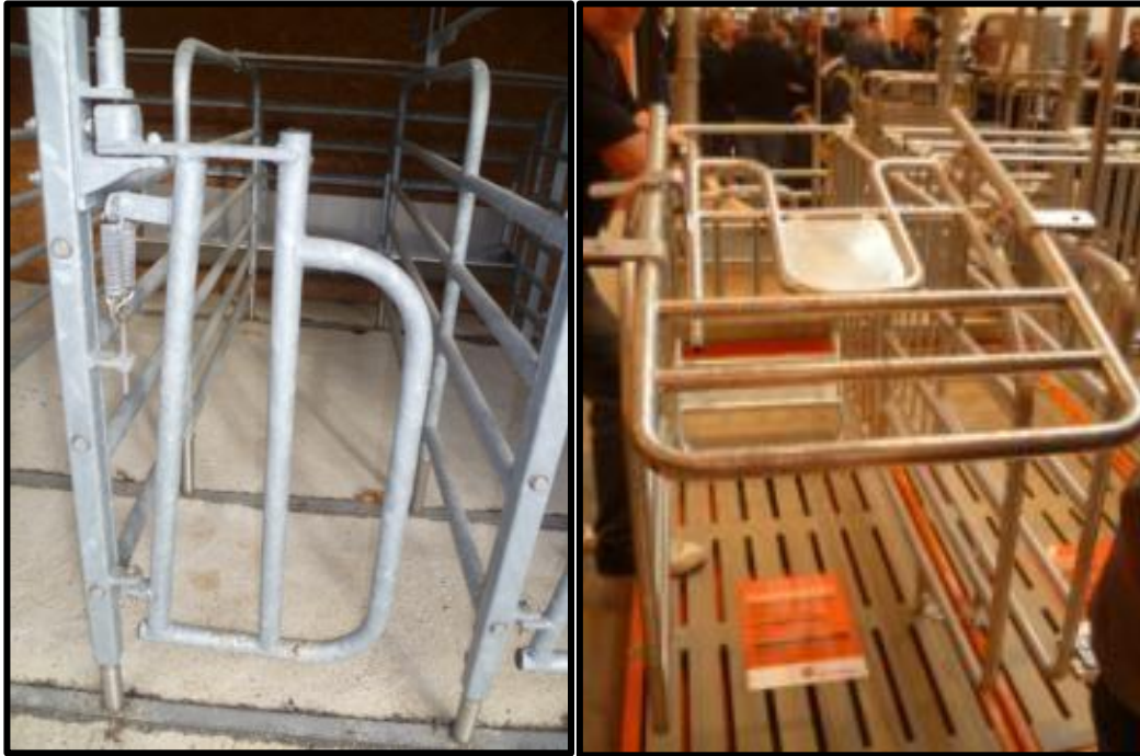
Figure 23 a) Réfectoire non autobloquant b) Réfectoire autobloquant
