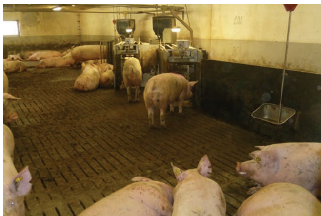
Le distributeur automatique de concentrés (DAC) permet un contrôle individuel de l'alimentation des truies.
