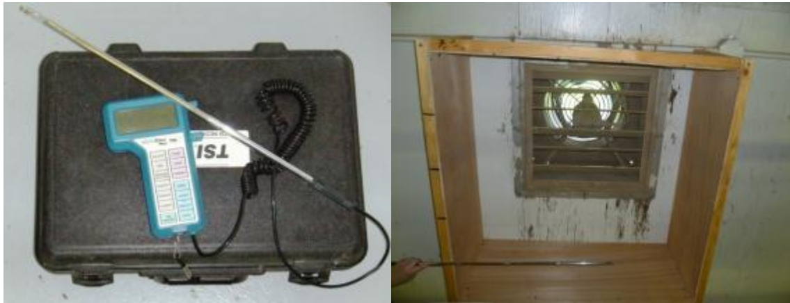
Figure 9 Anémomètre à fil chaud et boîte utilisée pour mesurer la vitesse d'air au ventilateur
