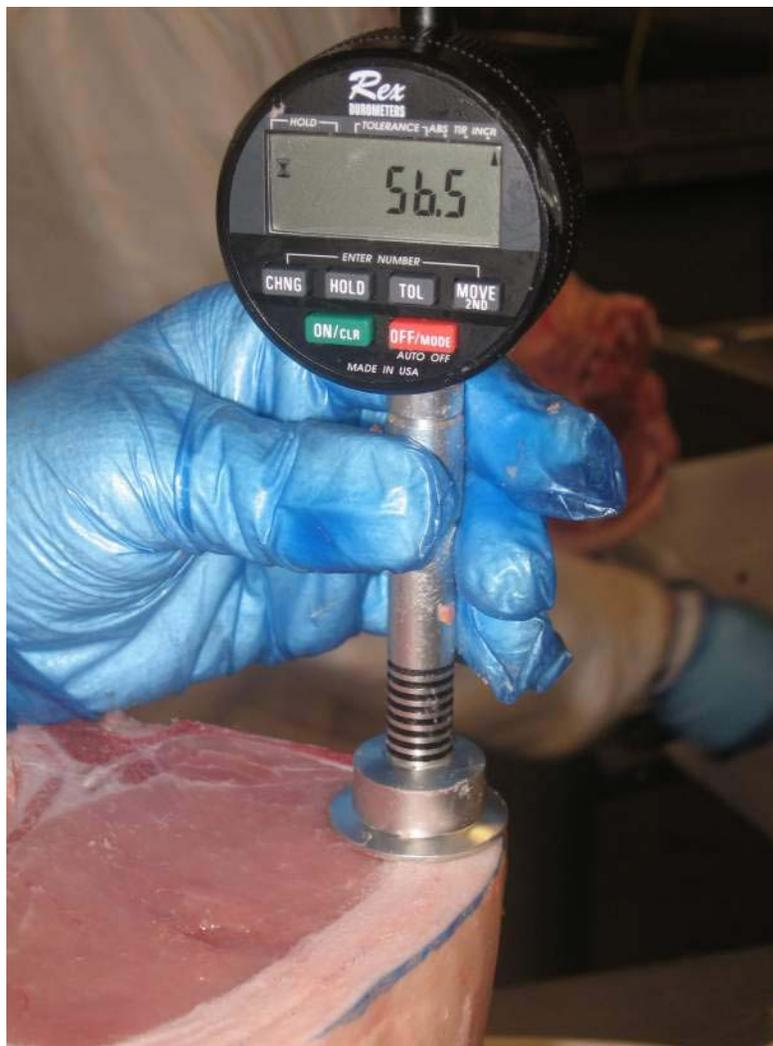
Figure 1 - Duromètre et exemple de site de mesure sur une couche de gras
