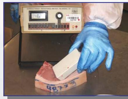
Figure 2. Conductivimètre de laboratoire utilisé pour la mesure de la CE
