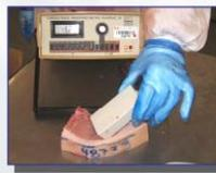
Figure 2. Conductivimètre de laboratoire utilisé pour la mesure de la CE
