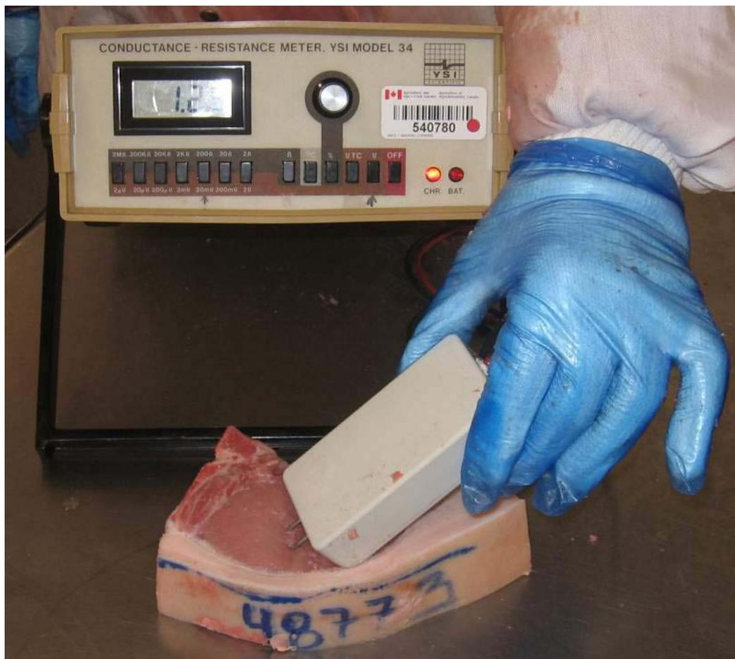
Figure 1 - Conductivimètre de laboratoire, sonde et exemple de site de mesure sur la longe
