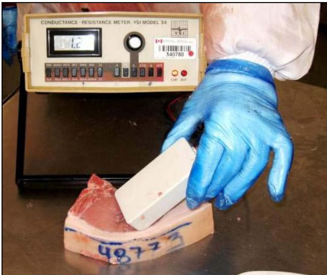
**Figure 3. Conductivimètre de laboratoire utilisé par Riendeau *et al.* (2009) pour mesurer la conductivité du muscle LD**
