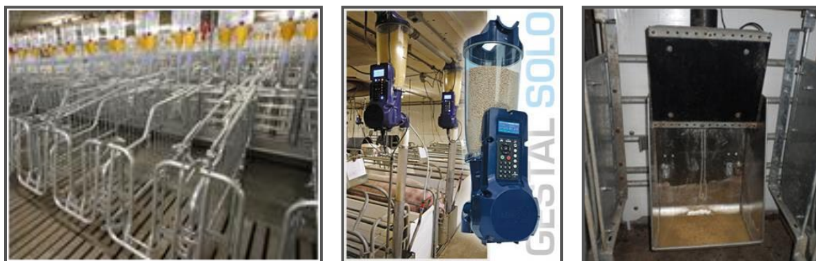
Figure 62 Composition du DAC autobloquant pour les truies gestantes en groupe proposé par Jyga Technologies inc.
