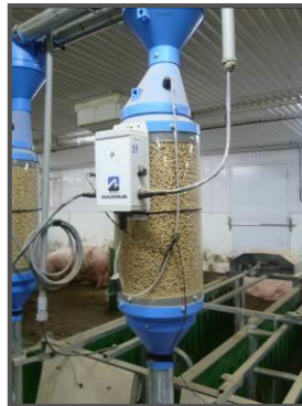
Figure 64 Composition du DAC autobloquant proposé par IEL
