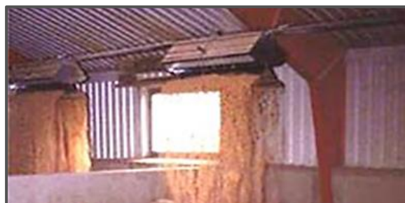
Figure 9 Système de doseur et équipement permettant la distribution de moulée sur une grande superficie de plancher
