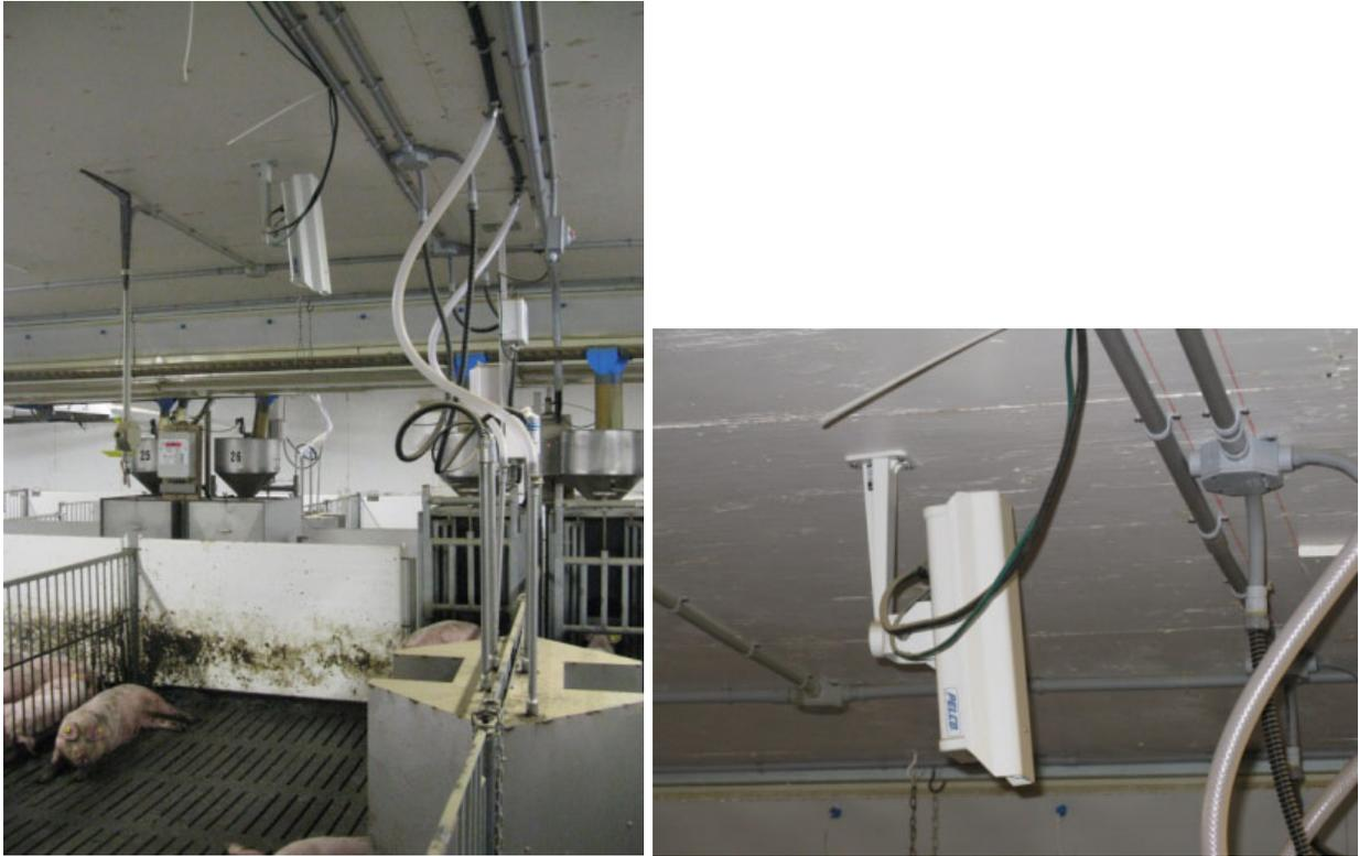
**Figure 4** Caméra infrarouge FLIR A325cs installée à la Station
