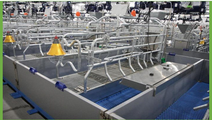
Cases ascenseurs dont le plancher est à l'état initial au sol (à gauche) ou soulevé (à droite)
