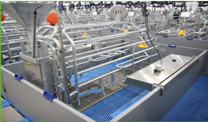
Cases ascenseurs dont le plancher est à l'état initial au sol (à gauche) ou soulevé (à droite)
